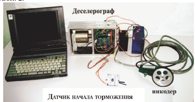
Рис. 3. Измерительное оборудование передвижной лаборатории
