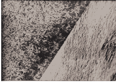
Рис. 4. Вид режущей кромки, заточенной комбинированным электроалмазным методом
