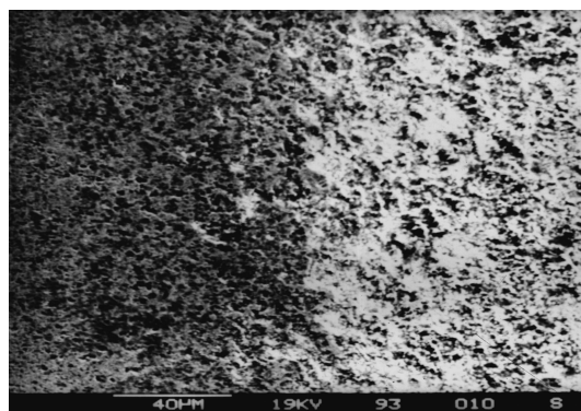
Рис.8. Вид передней поверхности пластины КНТ-16, шлифованной на режимах: V_{кр} = 35 \text{ м/сек} ; S = 1,25 \text{ м/мин} ; i_{тр} = 40 \text{ А/см}^2 ; t = 0,03 \text{ мм/дв.ход} ; i_{пр} = 0,2 \text{ А/см}^2
