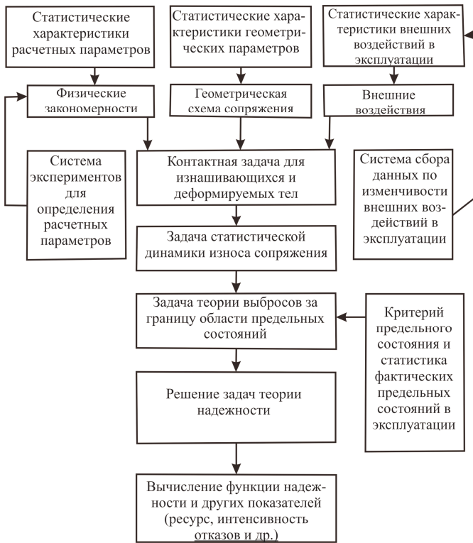
Рис. 1. Общая схема расчёта надёжности трибосопряжений по износу
