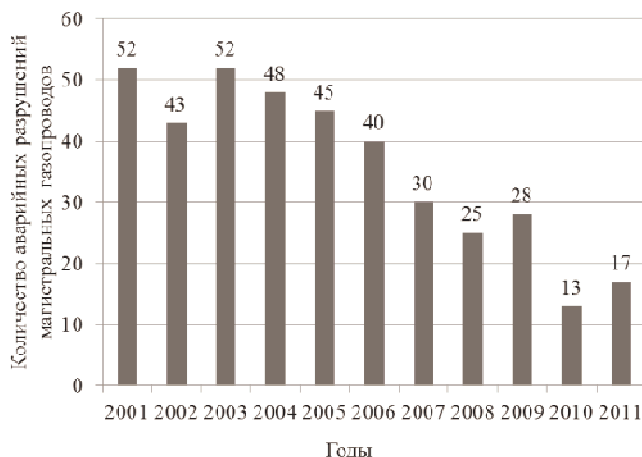
Рис. 1. Статистика аварийных разрушений магистральных газопроводов в 2001-2011 годах
