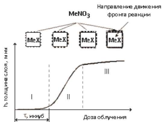
Рис. 5. Зависимость скорости ( v ) реакции от времени ( t ): I – инкубационный период (реакция идет с такой малой скоростью, что чувствительности приборов не хватает для ее фиксации); II – автокаталитический период (заметное увеличение скорости реакции вследствие роста границы раздела между твердыми фазами); III – период завершения реакции (скорость падает из-за уменьшения фронта реакции)
