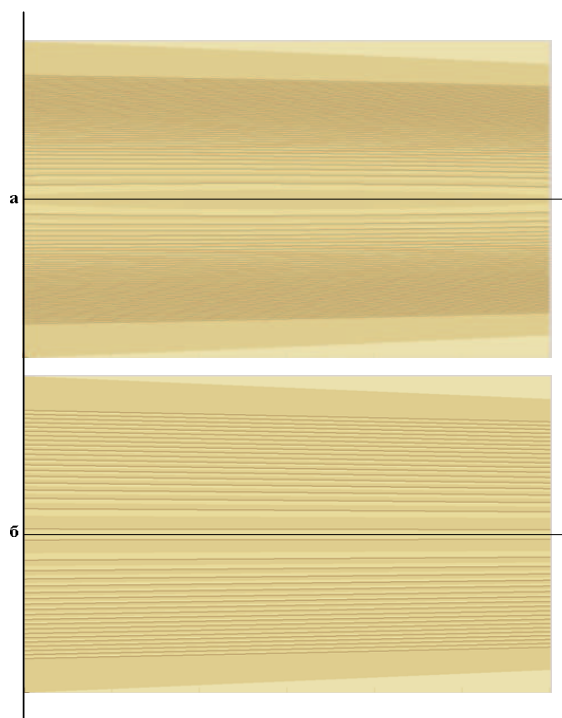
Рис. 7. Сравнение текстуры слоя древесины (шпона), полученной с помощью различных моделей в заданной плоскости реза, параллельной образующей кряжа: а) сортимент имеет форму усеченного параболоида и переменную ширину годичного слоя; б) сортимент имеет форму усеченного конуса и постоянную ширину годичного слоя.
