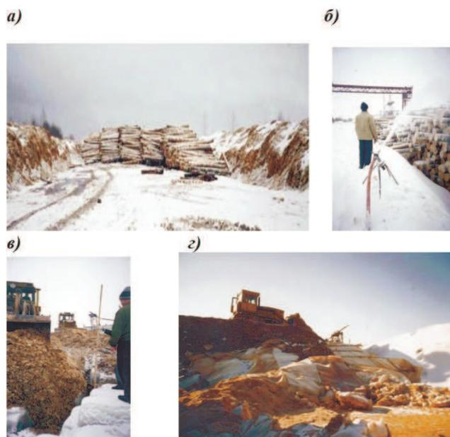
Рис. 3. Процесс формирования штабеля с использованием заморозки и снегования: а) укладка штабеля и создание запасов теплоизолятора; б) проливка и заморозка штабеля; в) закладка датчиков температуры; г) создание теплоизолирующего слоя.
