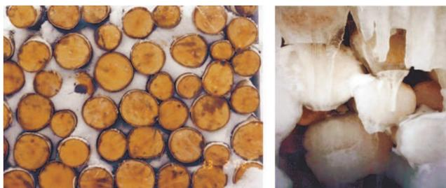
**Рис. 1.** Хранение круглого древесного сырья методом снегования (слева) и заморозки.
