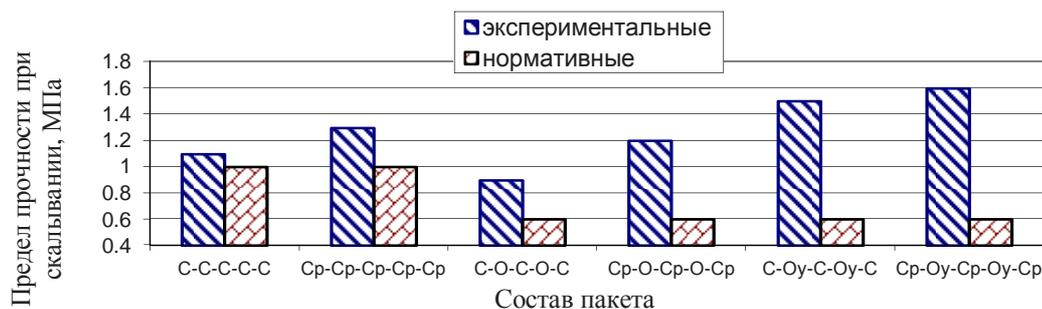
Рис. 4. Зависимость прочности при скалывании от состава пакета.
