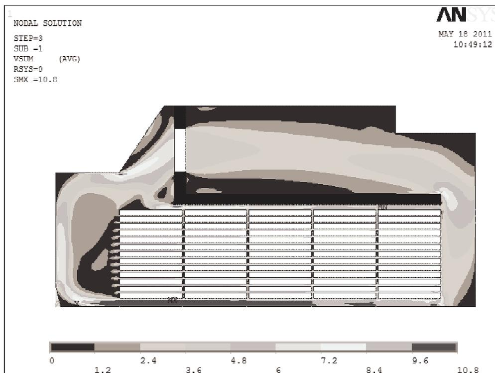
Рис. 3. Поля скорости рабочего агента в сушильной камере ЦНИИМОД-49 с заложеным штабелем.
