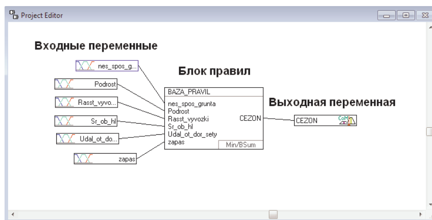
Рис. 3. Графическое представление проекта системы нечеткого вывода в программе fuzzyTECH
