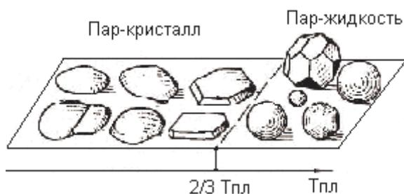
**Рис. 2. Схема изменения форм роста частиц конденсатов легкоплавких металлов при изменении температуры**
