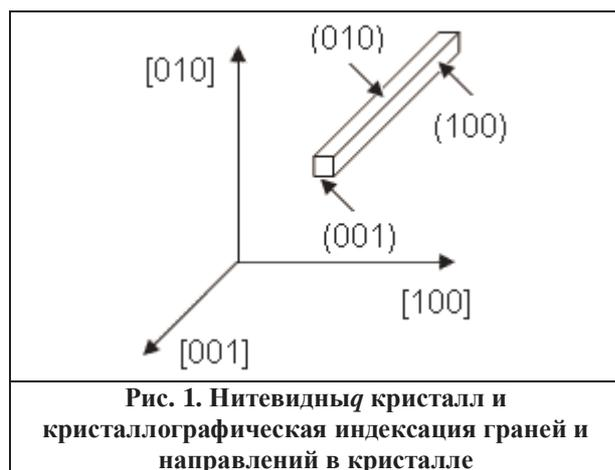
Рис. 1. Нитевидный кристалл и кристаллографическая индексация граней и направлений в кристалле
