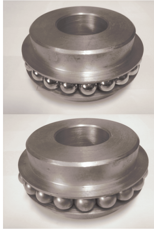
Рис. 5. Варианты исполнения поршня с шариками.
