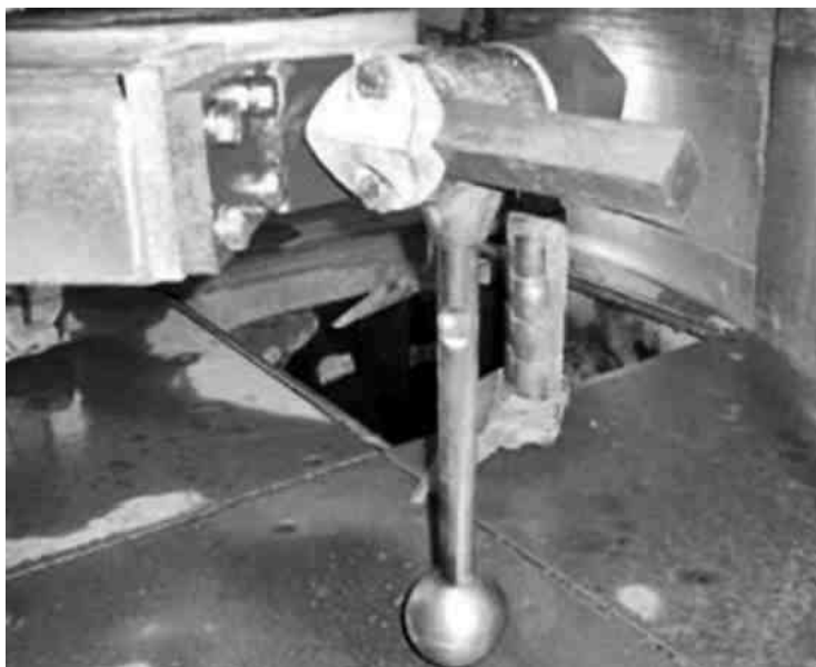
Рис. 7. Viscorobe, установленный на смесительной звездочке планетарного бетоносмесителя Соуврот емкостью 1,5 куб. м на предприятии SBP (Samer – Франция).
