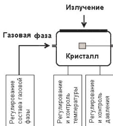
Рис. 2. Физическая модель для изучения воздействия ионизирующего излучения на гетерогенные реакции кристалл/газовая фаза.
