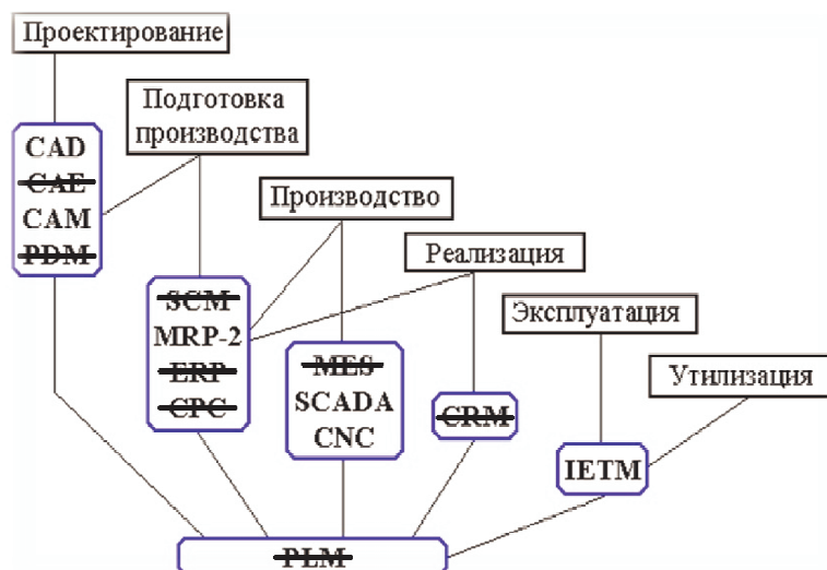
Рис. 2. Типичная схема взаимосвязи САПР пакетов с ЖЦ изделия в условиях мелкосерийного производства.
