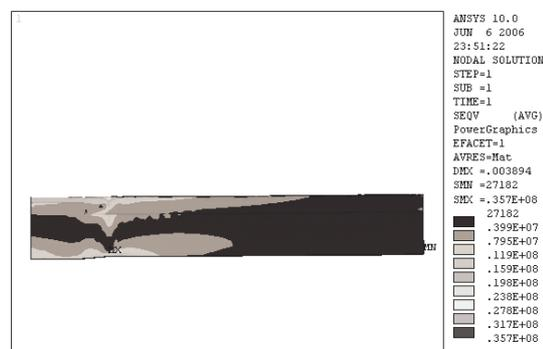
Рис. 4. Поле напряжений модели пера лопасти.
