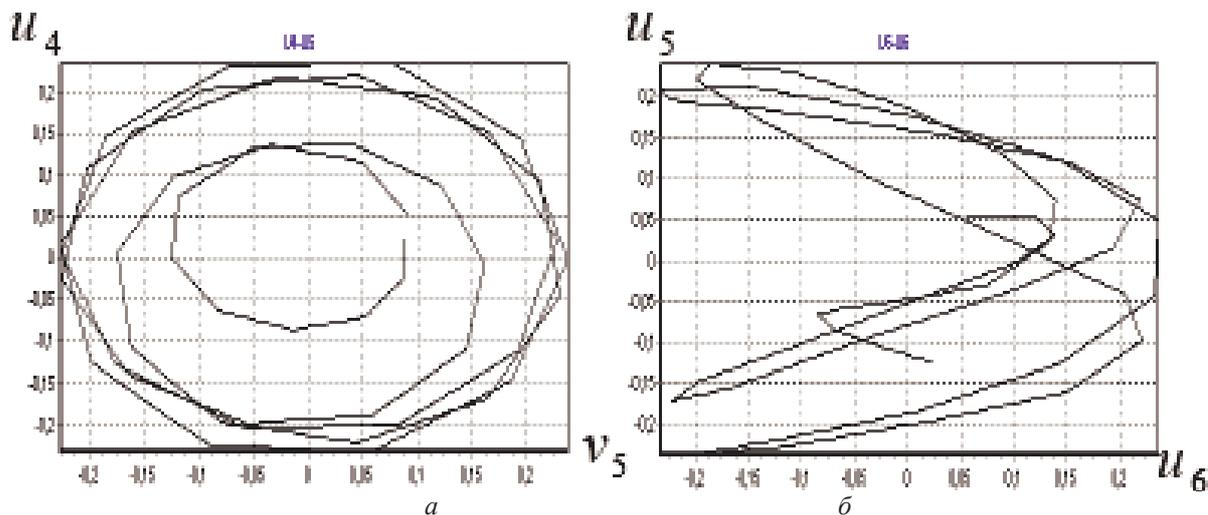
Рис. 3. Графики, образованные парами собственных векторов: а – высокое качество разложения; б – низкое качество разложения
