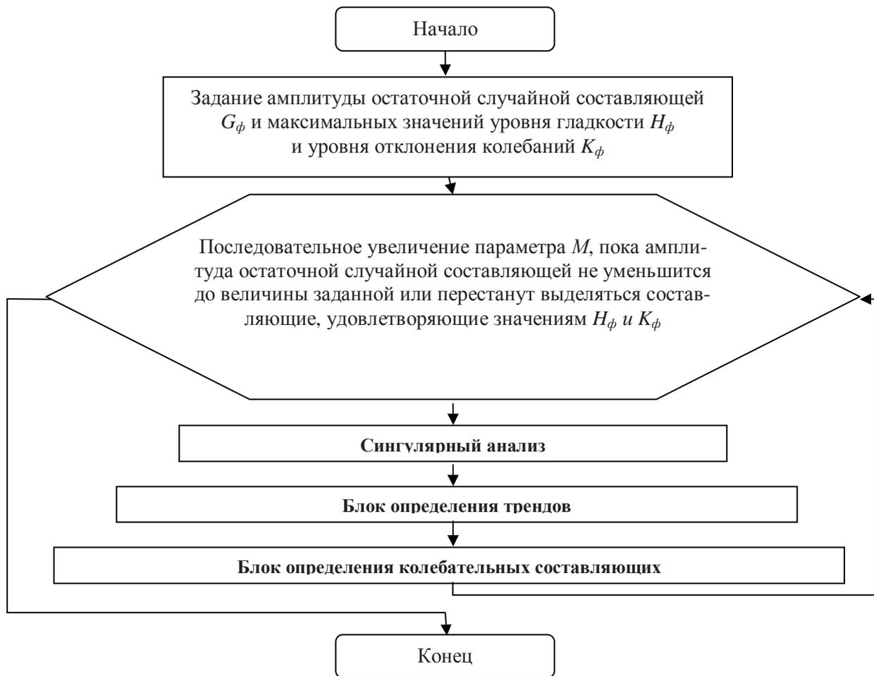
Рис. 6. Блок схема методики модифицированного сингулярного разложения исходной выборки с использованием графических критериев качества
