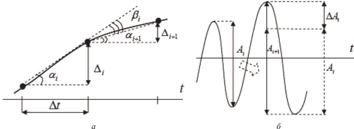
Рис. 4. Определение базовых параметров: а – для критерия уровня гладкости; б – для критерия уровня соответствия колебаниям
