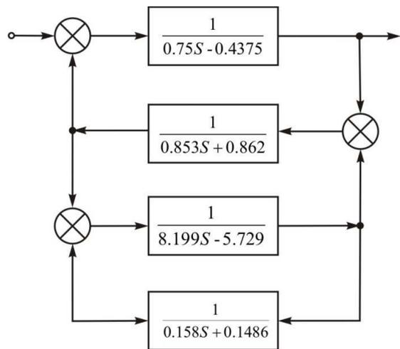
Рис. 2. Структурная схема, реализующая разложение с помощью цепной дроби
