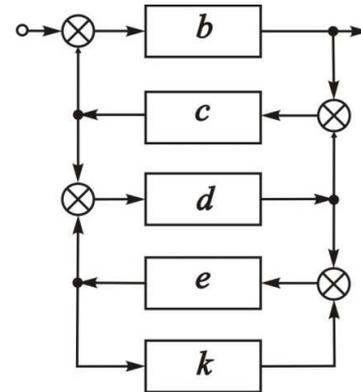
Рис. 1. Структурная схема, реализующая разложение с помощью цепной дроби
