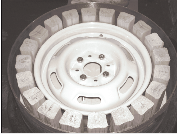
Рис.7 – Пресс-форма для изготовления колеса с полиуретановой шиной с упругими деформируемыми спицами
