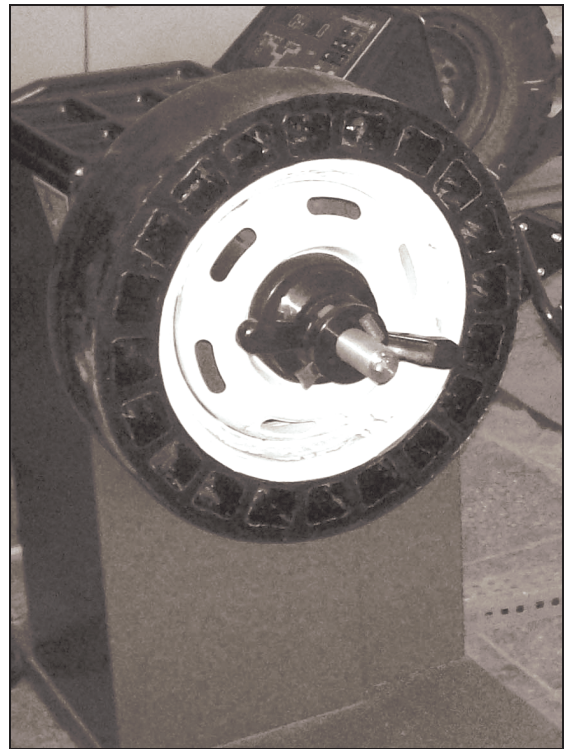
Рис.8 – Колесо с полиуретановой шиной с упругими деформируемыми спицами
