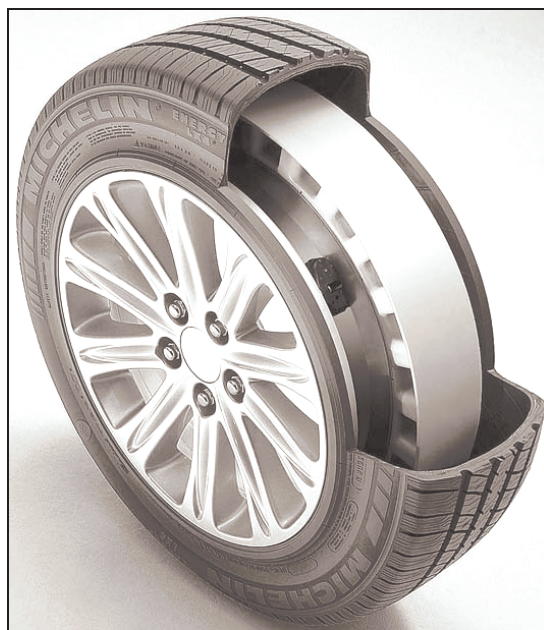
Рис. 3. Пневматическая шина Michelin PAX с эластичной кольцевой вставкой [4]
