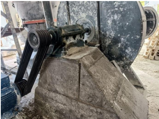
Рис. 4. Укрепление фундамента рамы
