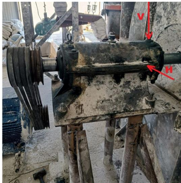
Рис. 2. Схема измерения вибрации
