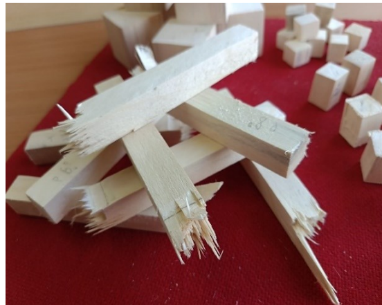
Рис. 1. Образцы затопленной осины для испытания механических свойств древесины
