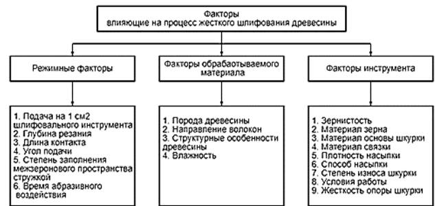
Рис. 1. Классификация факторов, влияющих на процесс жёсткого шлифования
