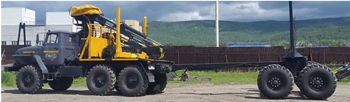
Рис. 4. Компонентная схема автопоезда: седельный тягач Урал-43204 + прицеп-ропусок ТМЗ 802
