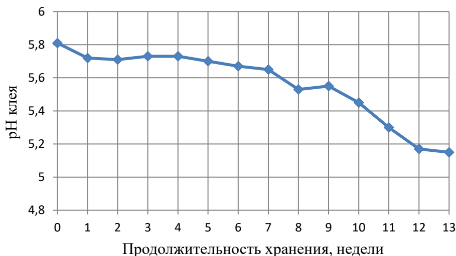
Рис. 3. Зависимость показателя рН клея на основе КФ-Ж от времени хранения
