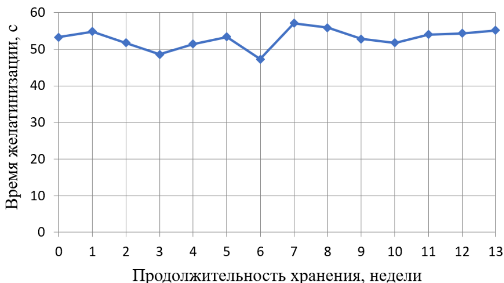
Рис. 4. Зависимость времени желатинизации при 100 °С смолы КФ-Ж от продолжительности хранения
