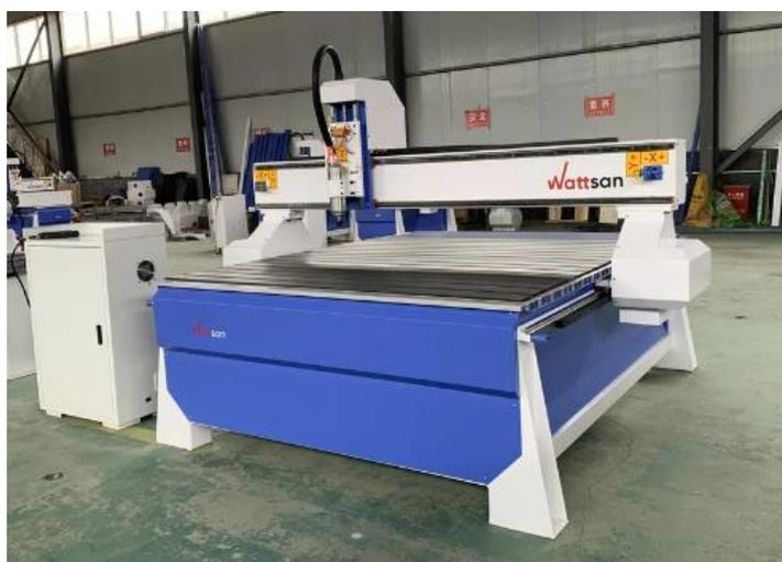
**Рис. 3.** Среднеформатный фрезерный станок Wattsan A1 1313
