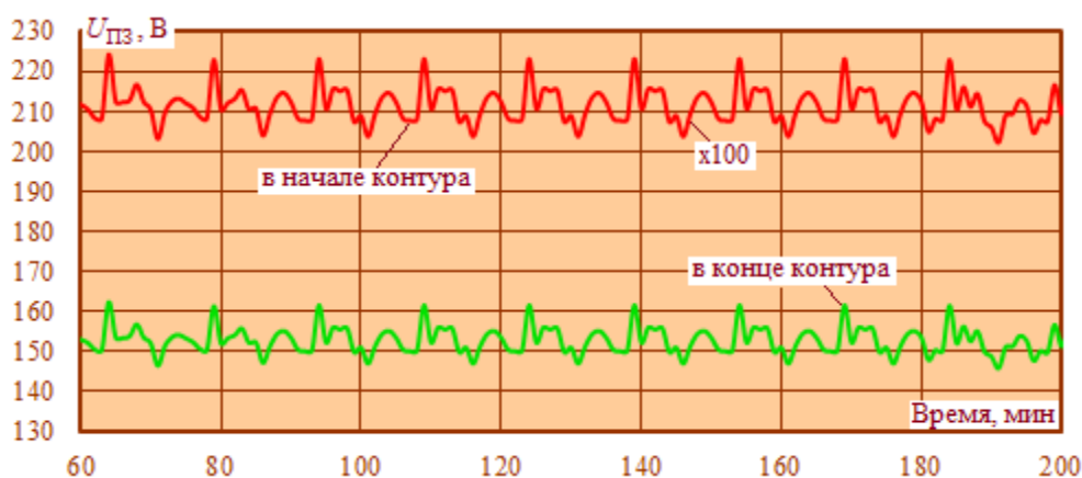
Рис. 12. Зависимость напряжения на поверхности земли
