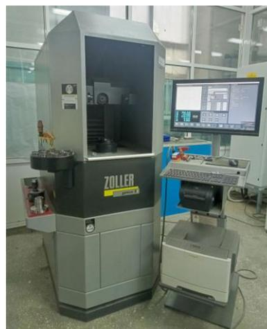
Рис. 10. Установка Zoller Genius III для контроля режущих инструментов
