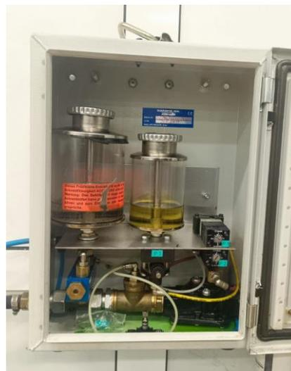
**Рис. 4.** Станция подготовки СОТС
