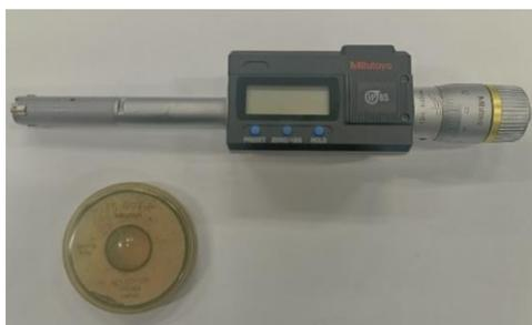
Рис. 8. Нутромер цифровой Mitutoyo серии 468-971
