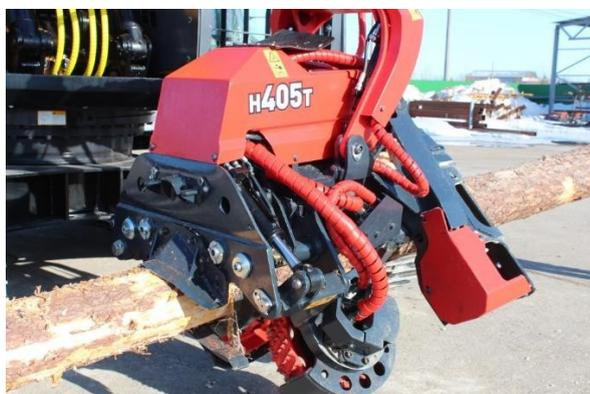
**Рис. 3.** Квазиотечественные решения. Продукция ООО «Трактородеталь». Харвестерная головка и система измерения LOGGER Распределители и моторы от ХГ WARATAH
