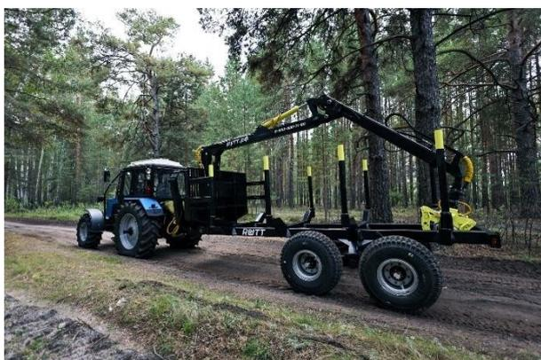
**Рис. 2.** КС (колёсный сортиментоподборщик) – форвардер на базе трактора Беларус МУЛ 82.2 + лесовозный прицеп RUTT к краново-манипуляторной установке (КМУ)
