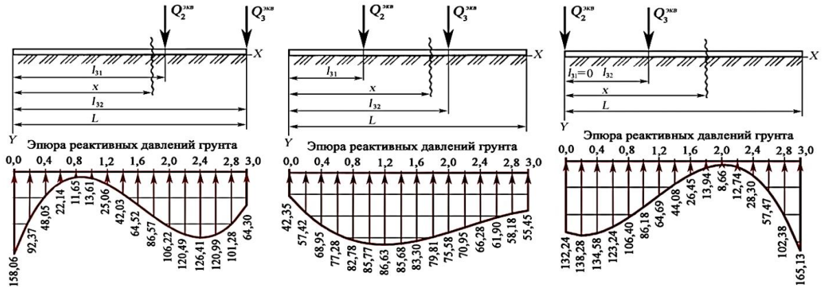
Рис. 6. Схемы приложения нагрузки ( Q_2^{экр} < Q_3^{экр} ) и эпюры реактивных давлений P грунта на уровне постели плиты
