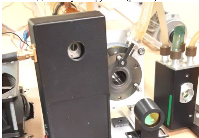
Рис. 12. Блок с датчиком МГ-30А (слева) и модулятором добротности (справа)
