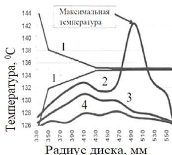
Рис. 8. Зависимость температуры статора от межножевого зазора: 1 — профиль межножевого зазора; 2 — зазор 0,3 мм; 3 — зазор 1,5 мм; 4 — зазор 2,0 мм
