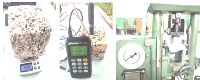
Рис. 2. Измерение массы, теплопроводности и прочности образцов
