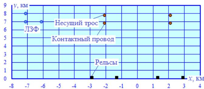
Рис. 9. Расположение токоведущих частей при использовании ЛЗФ
