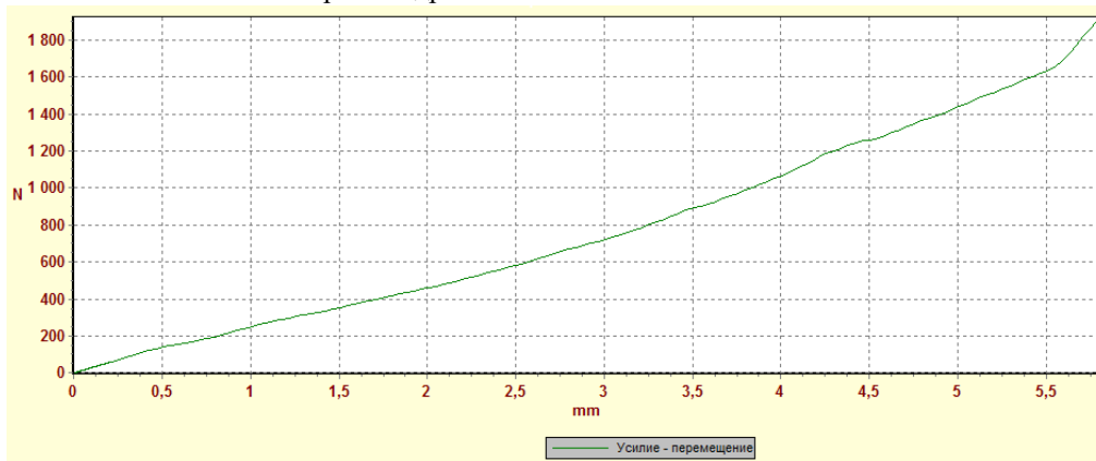
Рис. 5. Диаграмма «усилие – перемещение», полученная при внедрении стальных шипов d4xh6 в древесину сосны
