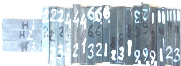
Рис. 1. Образцы из листового металлопроката стали 65Г для исследования микротвердости
