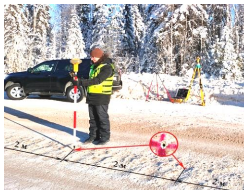
Рис. 2. Планово-высотная съемка координат точек оси закругления аппаратурой GNSS
