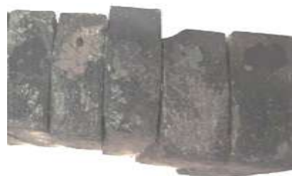
Рис. 4. Контрольные образцы после обжига
