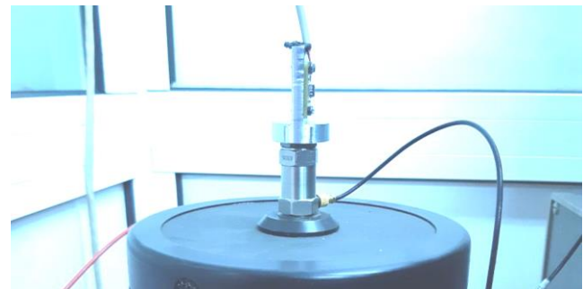
Рис. 5. Общий вид системы определения амплитудно-частотной характеристики разрабатываемого датчика
