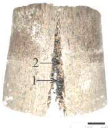
**Рис. 6.** Макроструктура фиброцементогрунтового образца: 1 — базальтовое фиброволокно; 2 — цементогрунтовая матрица
