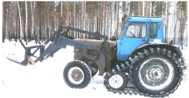
**Рис. 1.** Трактор МТЗ с полугусеничным двигателем (фронтальный погрузчик)
