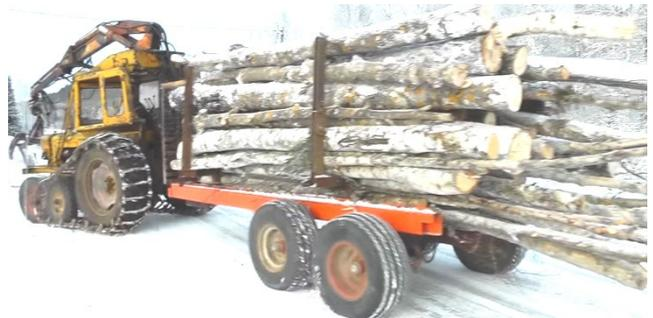
**Рис. 2.** Форвардер на базе трактора на полугусеничном ходу
