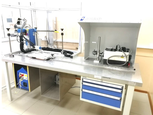
Рис. 3. Общий вид экспериментальной установки для определения остаточных напряжений рентгеновским методом. Источник: [27]
