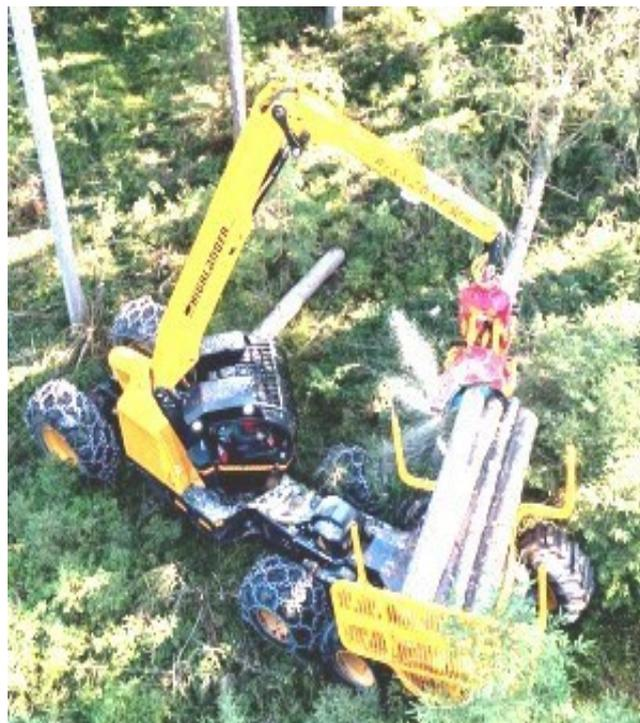
Рис. 3. Работа харвардера при раскряжевке
