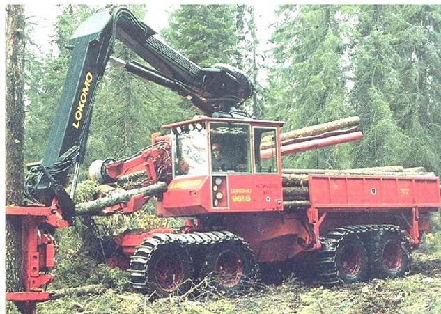
**Рис. 8.** Двухзахватный харвардер
