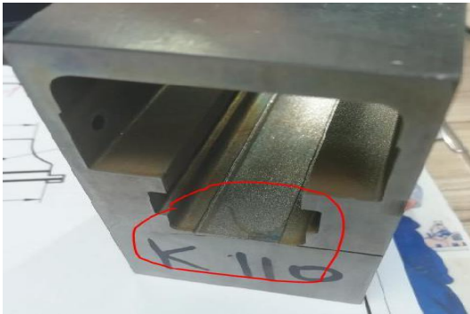
Рис. 1. Заготовка со сколом
