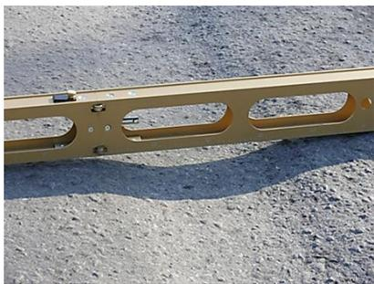
**Рис. 1.** Замер глубины колеи с использованием рейки РДУ-Кондор
