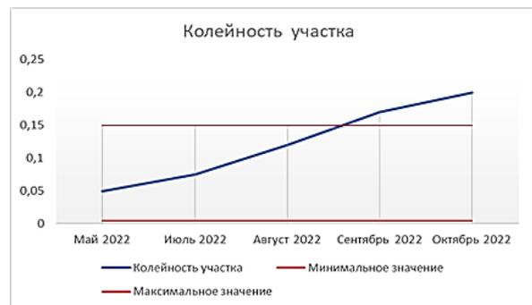
Рис. 5. Показатель поперечной ровности (колеиности) дорожных покрытий
