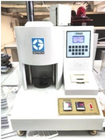
Рис. 2. Пластометр автоматический GT-7100 МВ
