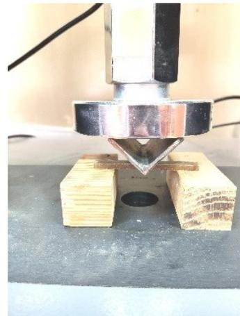
Рис. 4. Испытание образцов на изгиб
