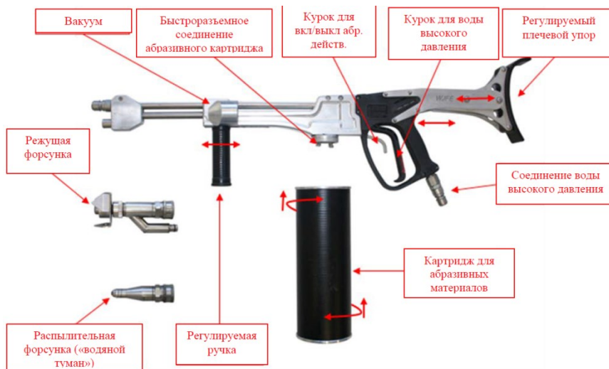
Рис. 7. Распылительный пистолет высокого давления компании Cristanini (Италия)
