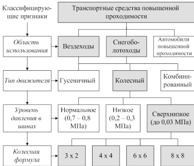
Рис. 1. Классификация вездеходных транспортных средств. Источник: [1]
