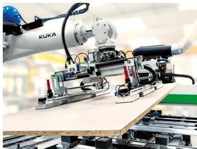
Рис. 1. Робот Kuka, осуществляющий сборку изделий из древесины
