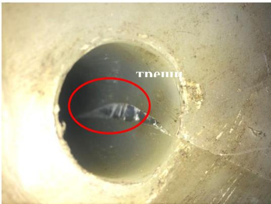
Рис. 5. Вторая половина корпуса эжектора
