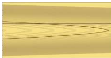
Рис. 3. Модель плоскости доски при резании параллельно продольной оси бревна
